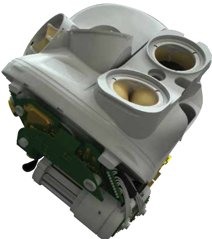
Volumes ventriculaires réservés, électronique et pompes miniaturisées
